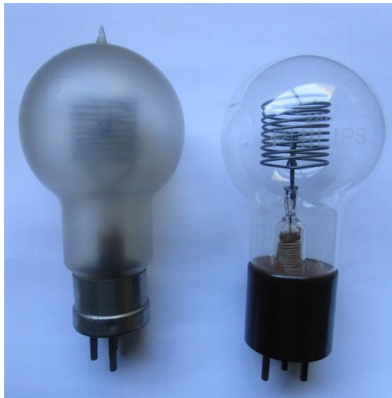
Het 1923 type neon lamp naast die uit 1925.
