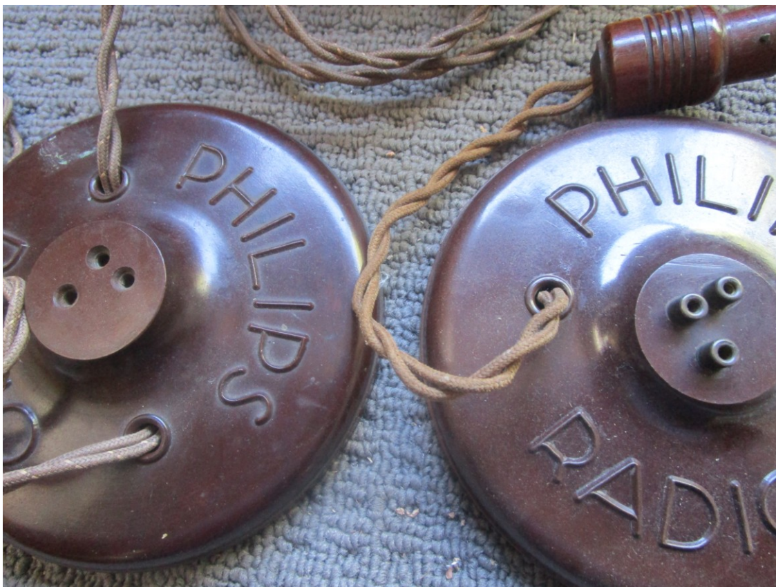
Het verschil in de buisvoet van het 1925 type met het 1923 type.
